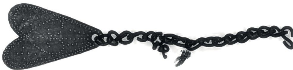
Figur 3. Röntgenbild av Objekt 01: Kedja med hänge (digitalt WELD filter som framhäver kontraster och kanter har använts, dessutom är bilden inverterad i gråskalan). Dekorativt mönster samt metallrester på textilfragmentet framträder. Bild: Magnus Mårtensson.
